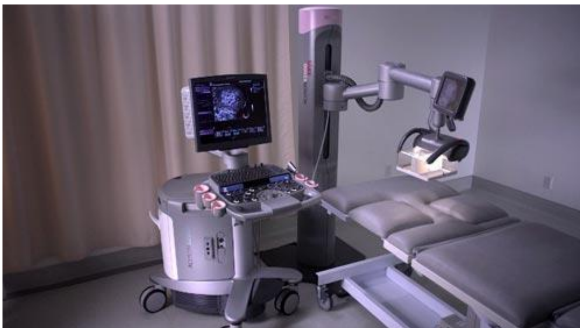
Рис. 8. Автоматизированный объемный сканер для молочной железы (ABVS) серии ACUSONS2000 производства компании Siemens.
